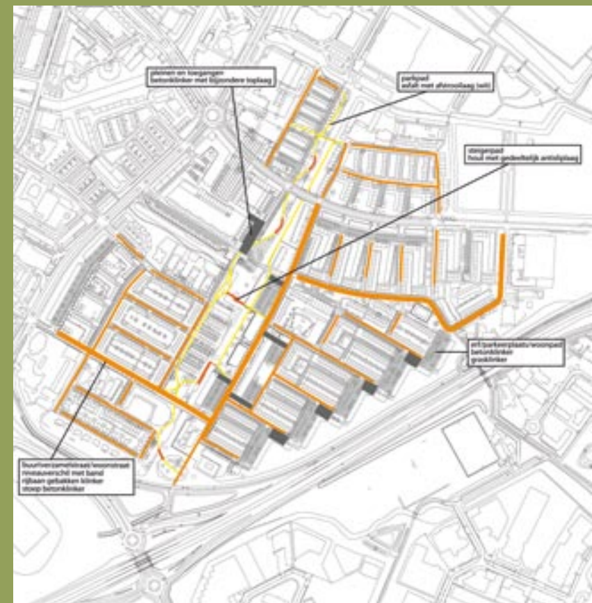
Rijbanen worden in de woonwijken van Nieuw-Overdie voorzien van straatbaksteen.
